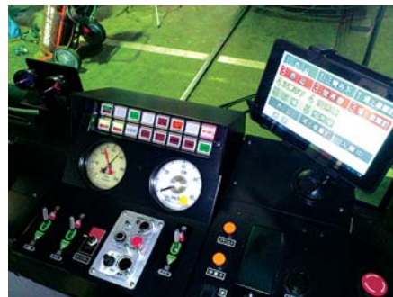
<図5：低床車の運転台に実装したアプリ搭載済の車載タブレット>
